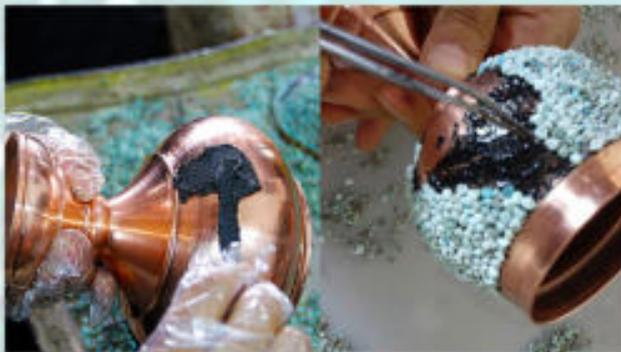
Der Arbeitsvorgang besteht aus zwei Prozessen. Zunächst wird der zu verzierende Metallgegenstand mit der Hand oder bzw. und einer Presse angefertigt. Danach werden die Reste von Türkisen, die aus den Werkstätten, in denen Türkise geschliffen werden, stammen, nach ihrer Größe geordnet. Und dann werden die Türkissteinchen in passender Größe auf dem Metallgegenstand angebracht.
