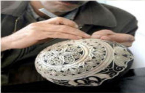
Drähte aus Gold, Silber und anderen Metallen werden in Ziermustern auf einen Grund des gleichen Materials gelötet. Ab dem 20. Jahrhundert werden die Drähte auch ohne Unterlage zu einem feinen, durchbrochenen Gespinst geflochten und nur an den Berührungspunkten gelötet. Die Materialstärke der Drähte beträgt bis zu 0,01 mm.
